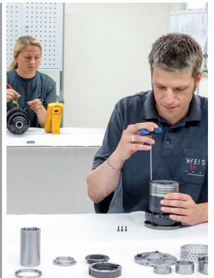
Spindelmontage erfordert große Sorgfalt und viel Erfahrung
